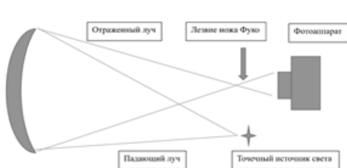
Рисунок 2 – Схема. Экспериментальная установка
