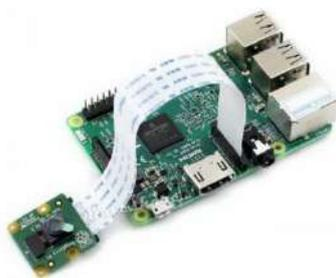
Рисунок 1 – Подключение модуля камеры к Raspberry Pi
